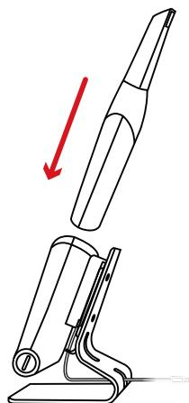
El Soporte del cargador debe estar conectado a una fuente de alimentación USB de tipo C para ser funcional.
