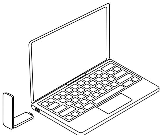
**NOTA:** Amplíe el adaptador inalámbrico para maximizar la intensidad de la señal de red.
