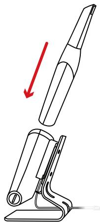
Il Supporto per caricabatterie deve essere collegato a una fonte di alimentazione USB di tipo C per funzionare.
