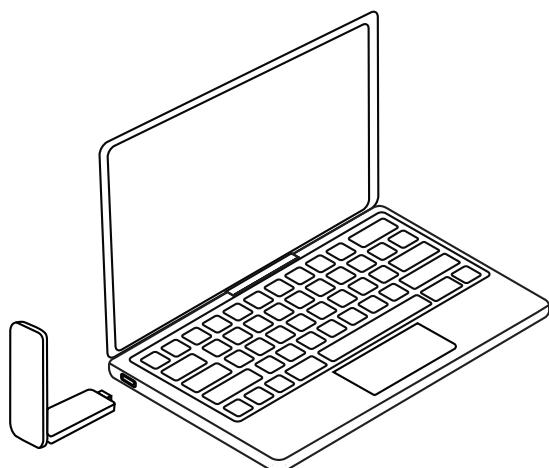
**REMARQUE:** développez l'adaptateur sans fil pour maximiser la puissance du signal du réseau.
