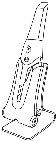
**NOTA:** Il Scanner si spegne automaticamente se rimane inattivo per più di 3 minuti. Se si desidera utilizzarlo di nuovo, premere un pulsante qualsiasi del Scanner o estrarlo dal Supporto per caricabatterie.
