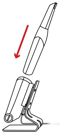
Die Ladehalterung muss an eine USB-Typ-C-Stromquelle angeschlossen werden, damit es funktioniert.
